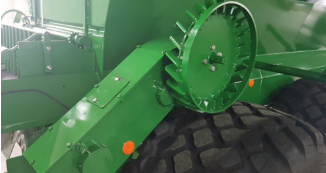
Bodenradantrieb mit Getriebe und Handschaltung
