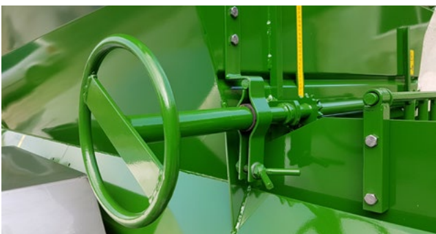
Einstellrad für Dosierschieber
