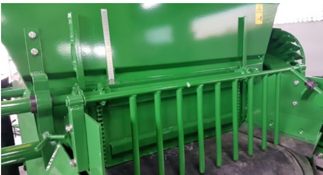
Dosierschieber mit Skala und Harke
