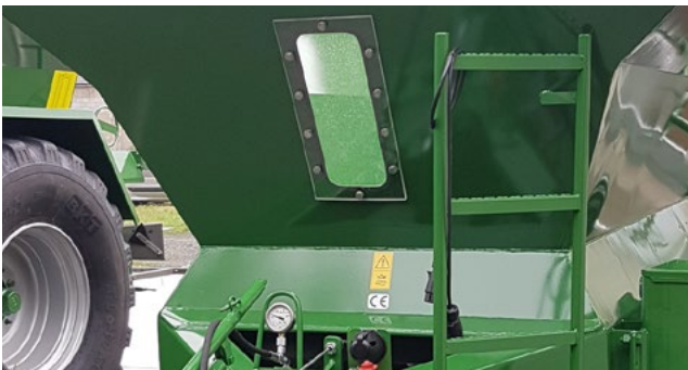
Manometer und Fenster
